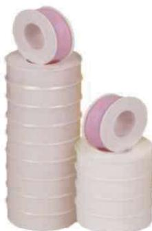
I nastri P.T.F.E. HD Rosa sono ad alta densità (1g / cm<sup>3</sup>) e quindi particolarmente indicati per temperature e pressioni elevate (es. impianti di vapore, pannelli solari, olio diatermico, etc.).
